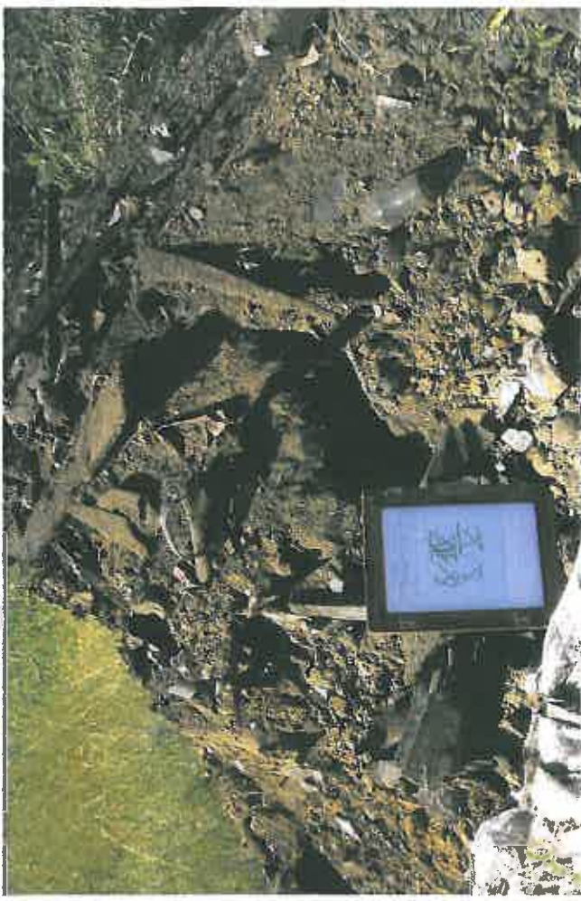
Foto 46: Schurf S10 im Bereich massiver Müllvergrabungen
